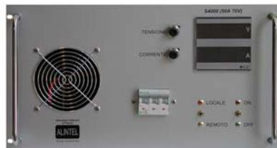
Gli alimentatori della serie SHV sono convertitori switching AC/DC regolabili in tensione (come opzione regolabili anche in corrente) progettati per tensioni fino a 60.000V, con possibilità di limitare il fondoscala di tensione e corrente mediante 2 potenziometri presenti sul pannello anteriore. La versatilità di questi alimentatori industriali è tale che, nel medesimo range di potenza, è possibile ottenere una ampia fascia di combinazioni tensione/corrente.
